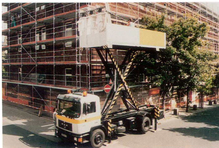
Podnośnik nożycowy z automatycznym poziomowaniem podpór.
