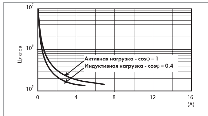
F 55 - Электрическая долговечность (АС) при ном. нагрузке Реле с 4 перекидными контактами
