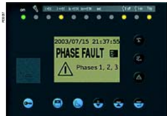
Сигнализация при местном управлении на передней панели Serap
