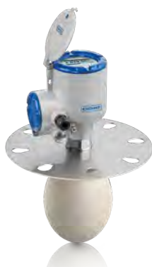
Каплевидная антенна DN150 из полипропилена с резьбовым присоеди- нением G1½ и фланцем низкого давления DN150
