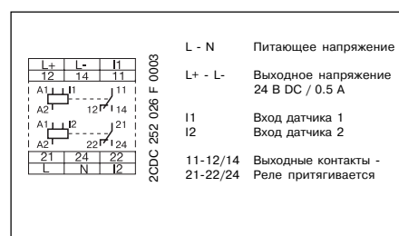
Схема подсоединения CM-SIS
