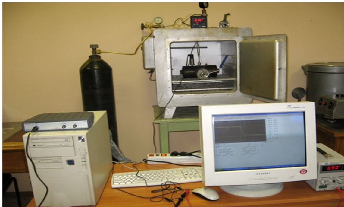
стенд для испытаний полимеров на устойчивость к взрывной декомпрессии (разработка С-Петербургского ГПУ)
