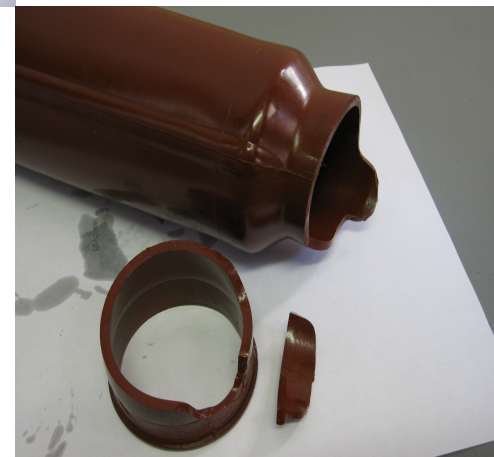
Диафрагма одного из российских производителей. После стендовых испытаний диафрагма деформировалась и разрушилась.
