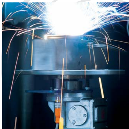
ecolink EVW - специальное покрытие обеспечивает устойчивость к сварочным окалинам.
